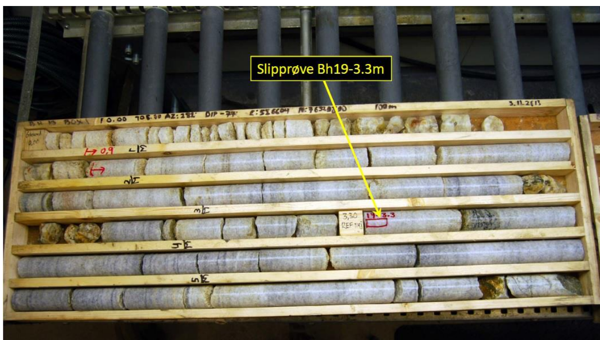
Figur 27: Kjerneboks med den aller øverste delen av Bh 19. Viser også hvor slippørven er tatt.
