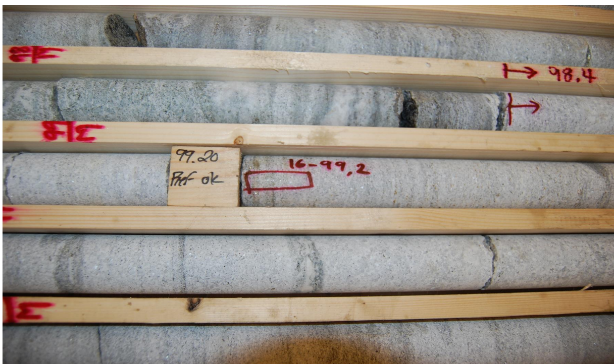
Figur 14: Eksempel på merking av prøvepunkt med tanke på mineralogiske undersøkelser. Eksempelet er fra BH 16 ved 99,2 meter nede i hullet.
