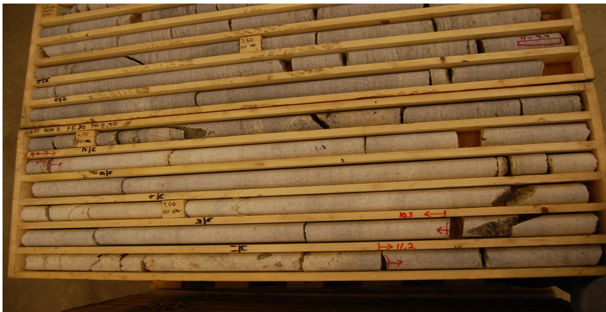
Figur 13: Merking av prøvers begynnelse og slutt i kjernebatter. Eksemplet er fra BH 11.
