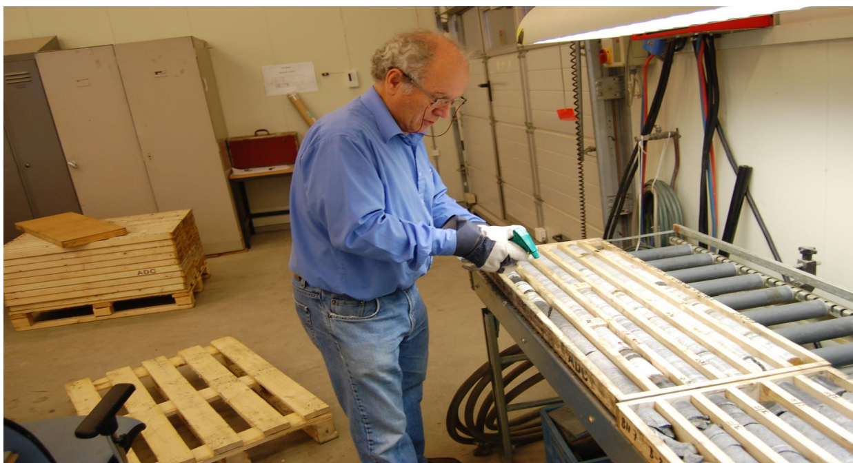
Figur 12: Undertegnede fukter kjernene før fotografering.
